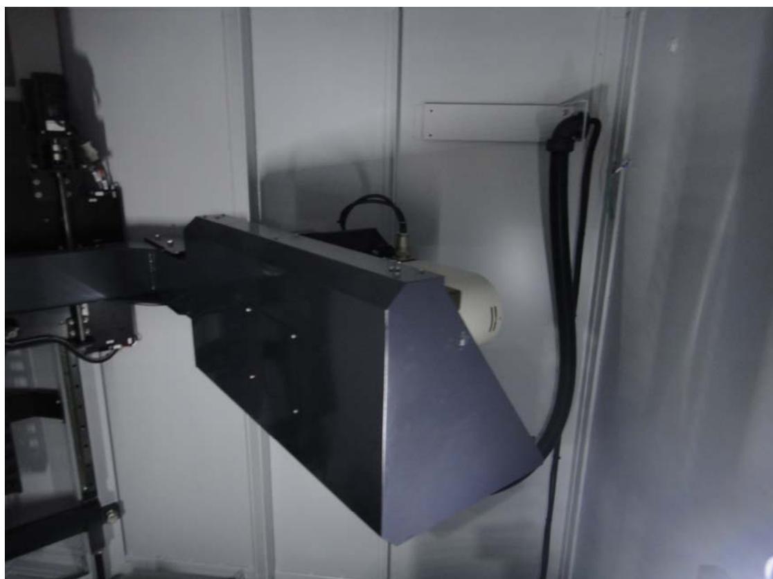
SMX-3500M X 射线透视检查机的射线管
