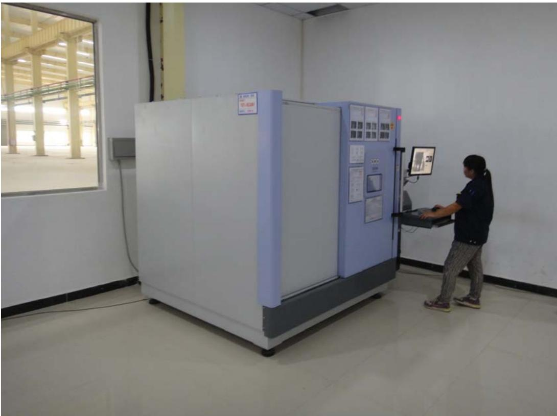
已安装的第一部 SMX-3500M X 射线透视检查机
