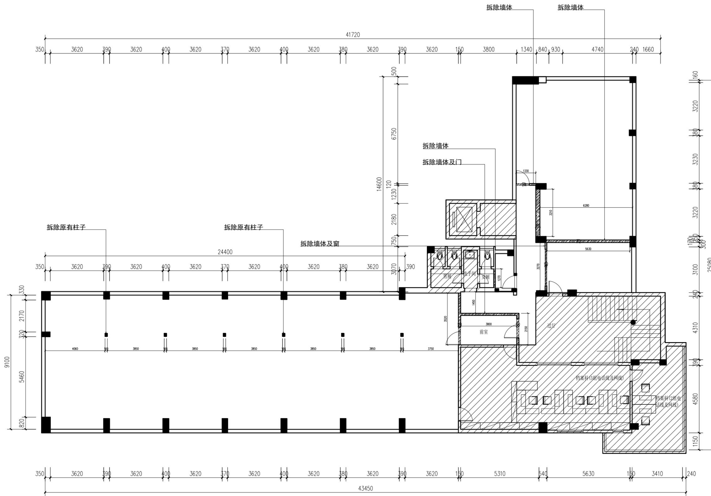
五层拆除平面图 1:100
