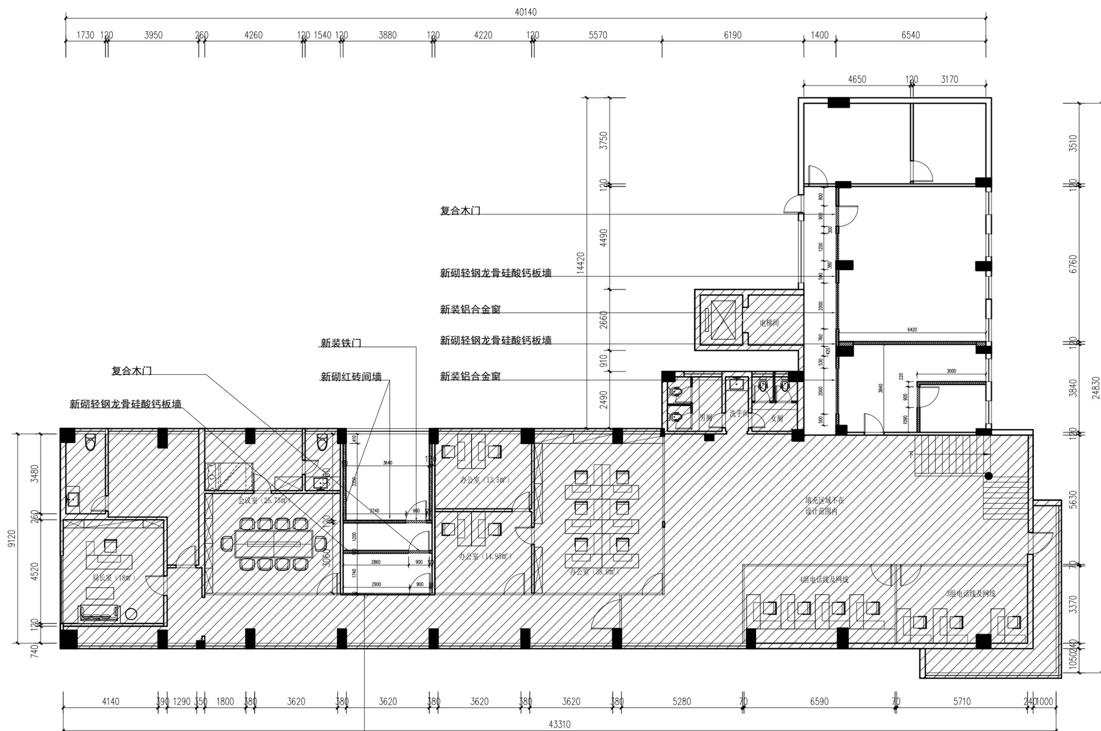
新砌轻钢龙骨硅酸钙板间墙图例
