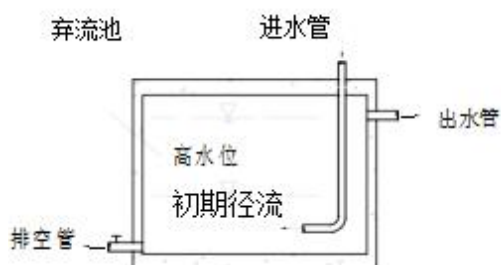
图 6-30 容积法弃流装置
