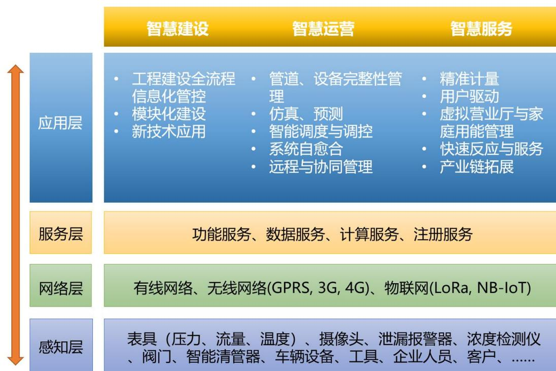
图 9.2-1 智慧燃气系统主要组成示意图
