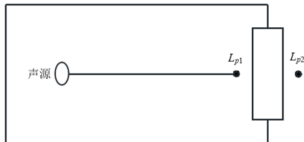
图 6.4-1 室内声源等效为室外声源图例
