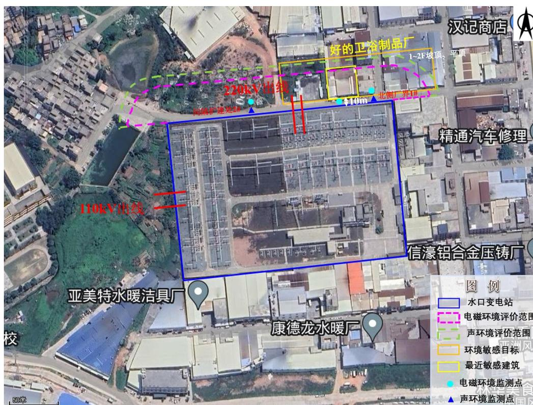
图 14 220kV 水口变电站间隔扩建侧及周围环境敏感目标监测布点示意图
