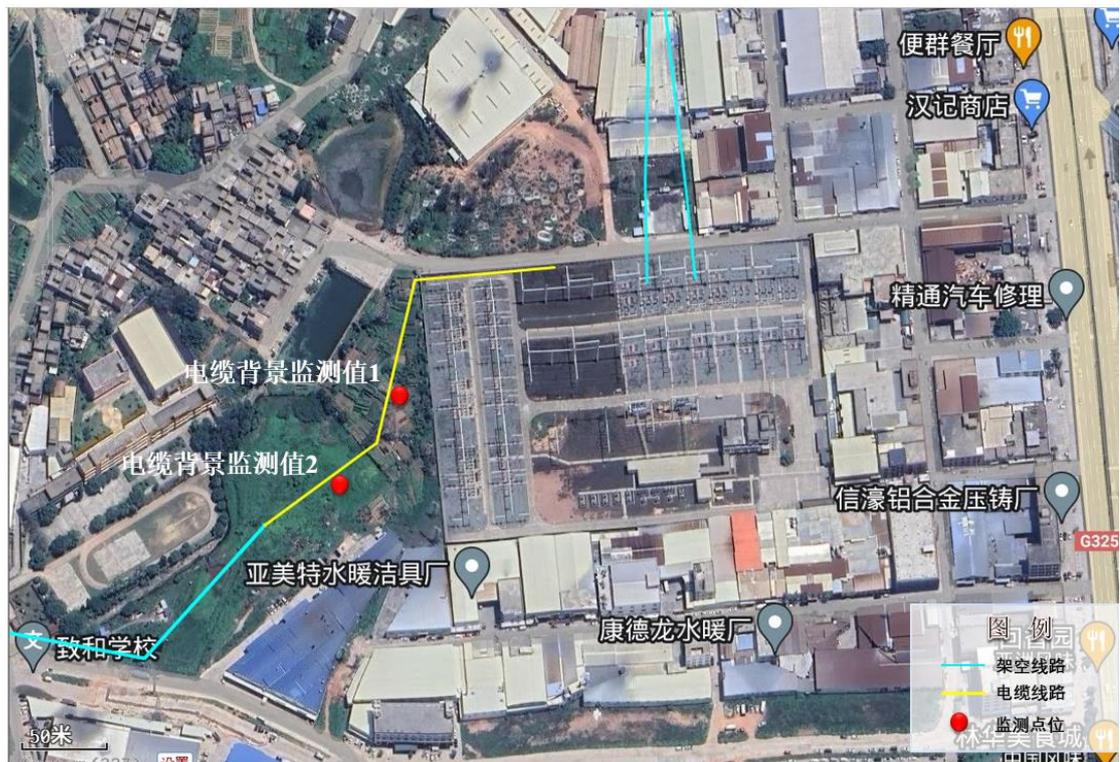
图 25 本工程电缆线路背景值监测示意图
