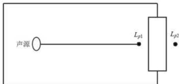
图 1.11-1 室内声源等效为室外声源图例
