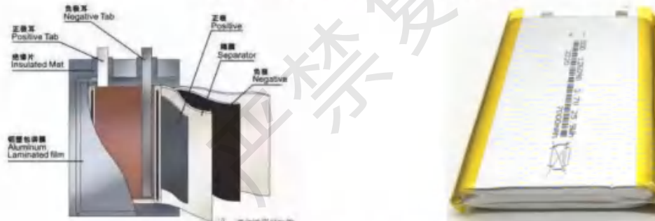
软包锂电池单体结构图与实体图
