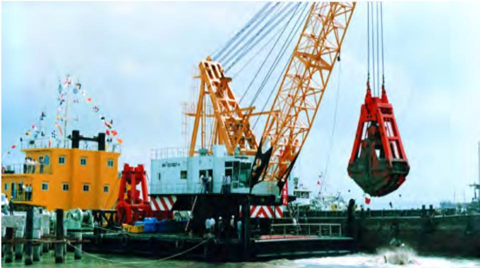
图 2.4.1-1 抓斗式挖泥船施工示意图
