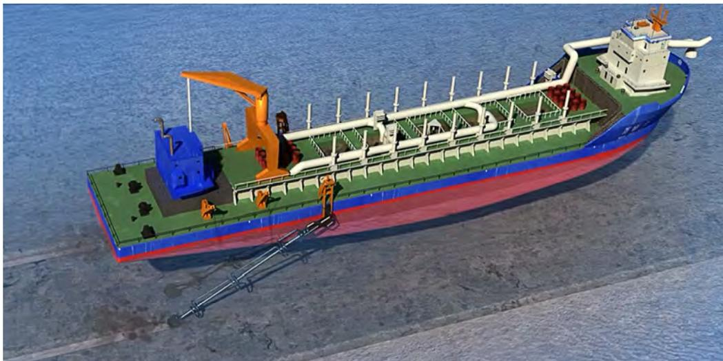
图 2.4.2-2 耙吸船施工三维示意图
