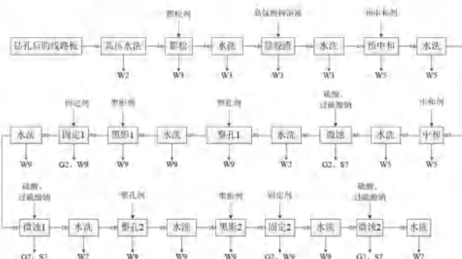
图2-14 黑影工艺流程
