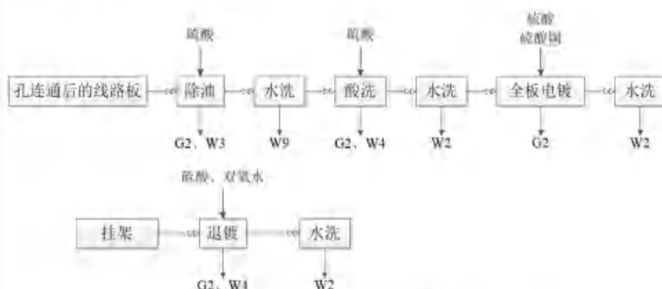
图 2-15 全板电镀工艺流程图
