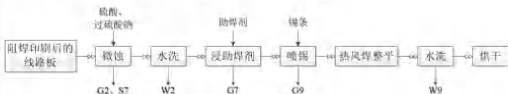
图2-21 喷锡工艺流程图
