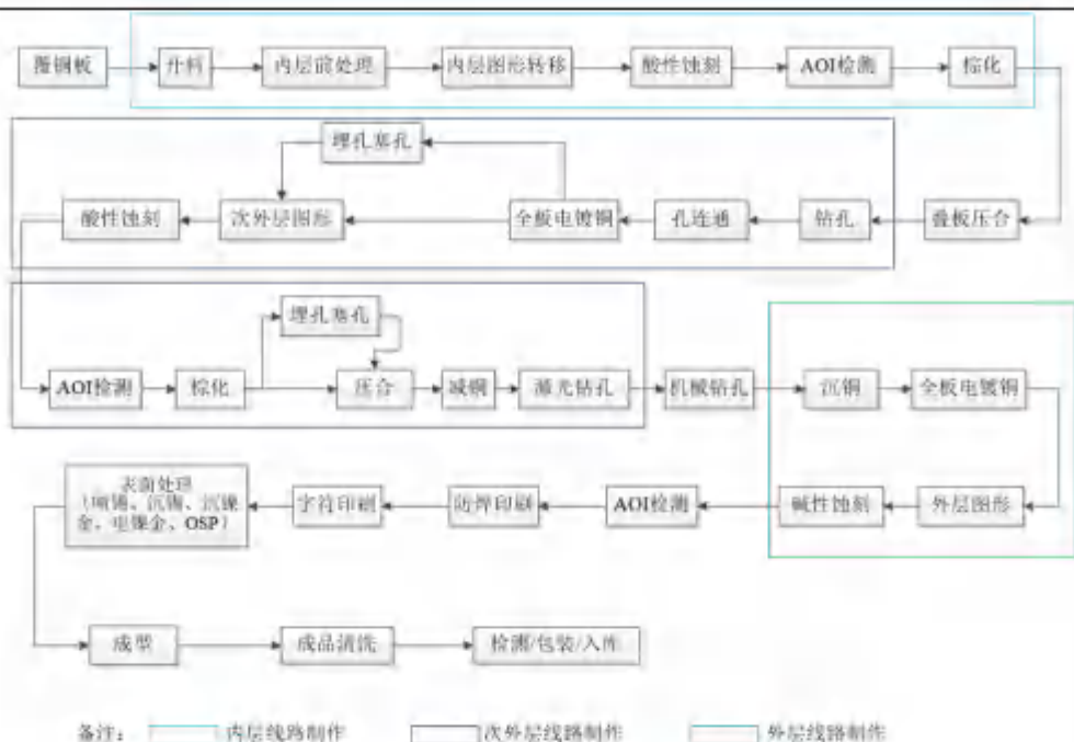
图 2-7 HDI 板（二阶盲孔）工艺流程
