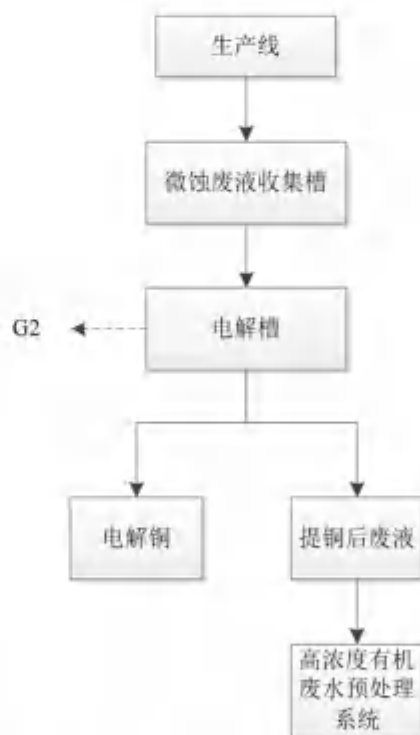
图 2-3 微蚀废液提铜系统工艺流程示意图
