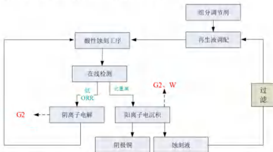
图 2-33 酸性蚀刻废液循环回收铜子项目子项目工艺流程及产污节点图
