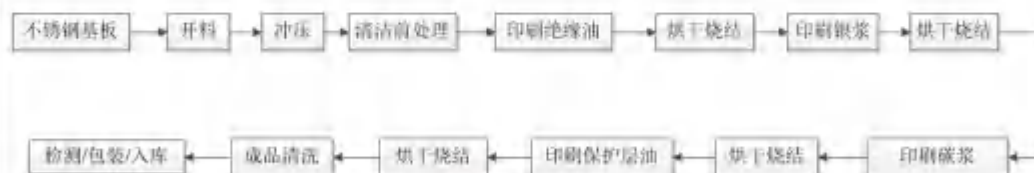
图 2-8 不锈钢基板工艺流程
