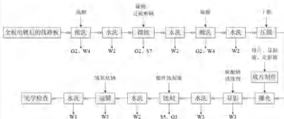
图 2-16 外层酸性蚀刻工艺流程
