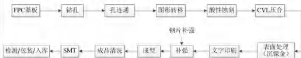
图 2-5 挠性版双面板工艺流程
