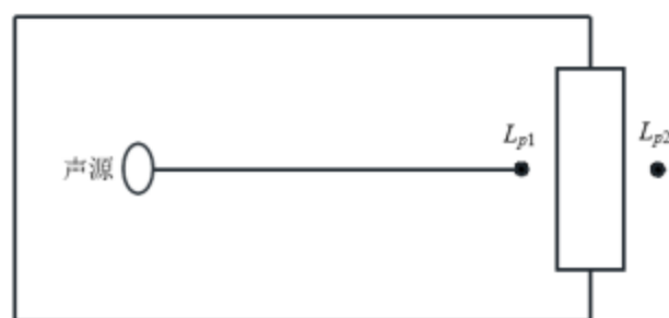
图 6.4-1 室内声源等效为室外声源图例
