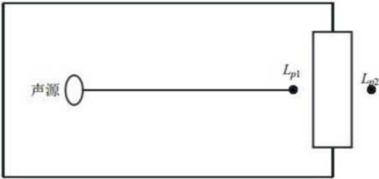
图 6.2-42. 室内声源等效为室外声源图例
