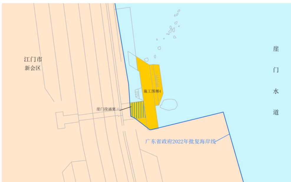
图 7.5.1-15 施工围堰 4 与崖门段涵窦二透水构筑物重叠示意图
