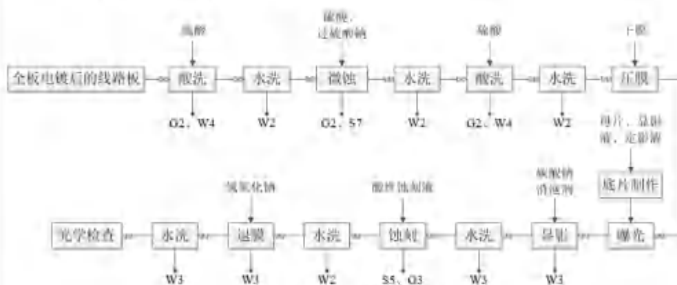
图 2-16 外层酸性蚀刻工艺流程
