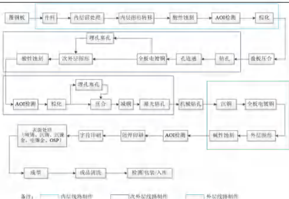
图 2-7 HDI 板（二阶盲孔）工艺流程
