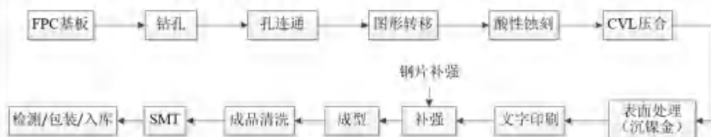
图 2-5 挠性版双面板工艺流程
