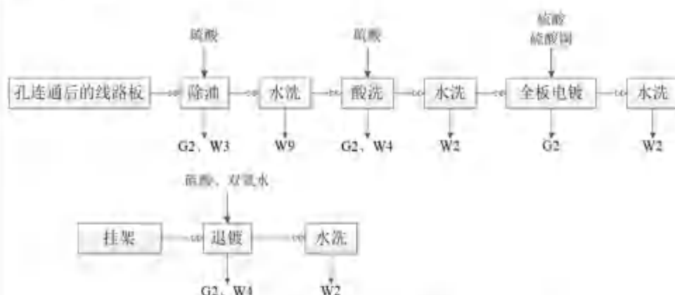
图 2-15 全板电镀工艺流程图
