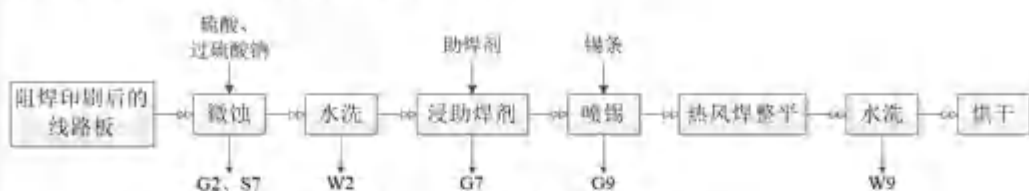
图2-21 喷锡工艺流程图
