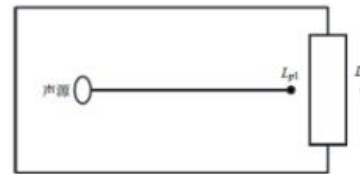
图 5 室内声源等效为室外声源图例
