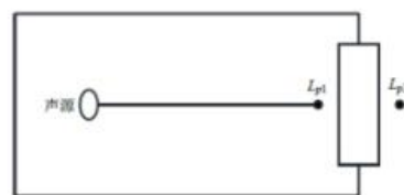
图 5 室内声源等效为室外声源图例
